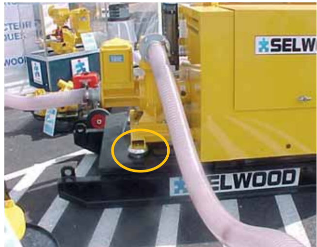
Pumpenlagerung mit Stabiflex
